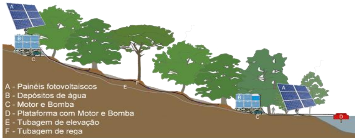
Figure 5.12 - Esquema conceptual do sistema de elevação de água. Imagem produzida utilizando o software versão estudante Adobe Photoshop [66].
